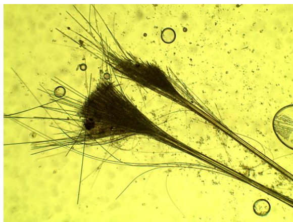
P8 Asbestfibre i kiselgur (100x forstørrelse)
