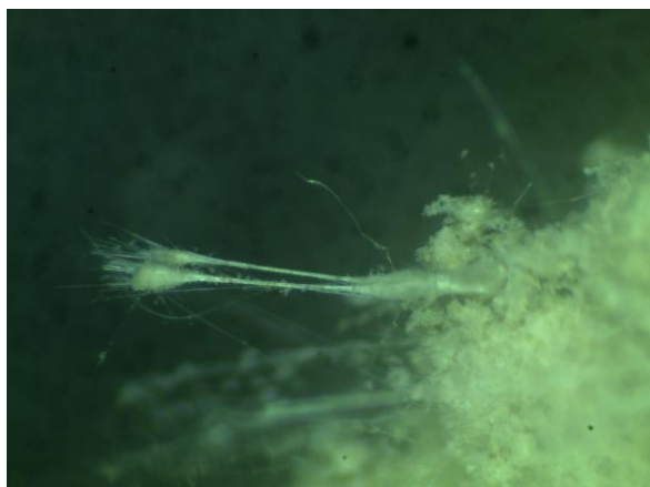
P8 Asbestfiber i Kiselgur (ca. 15x forstørrelse)
